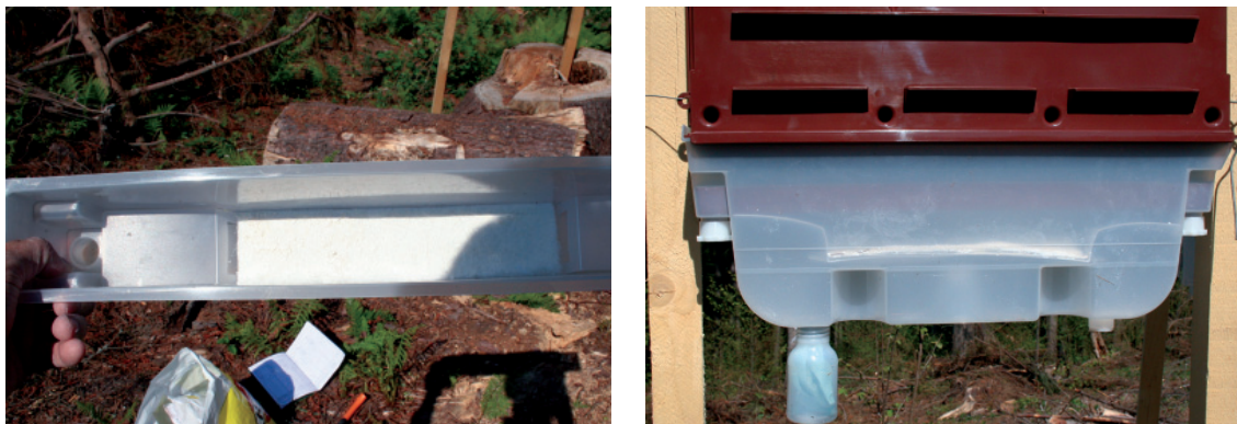
Obrázok 3, 4. Infikovaná vložka v zbernej nádobe lapača (vľavo) a zberná nádoba s fľašou na odber vzoriek určených na laboratórny rozbor (vpravo)
